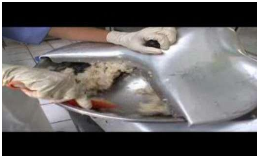
Gambar 21. Membuat adonan bakso dengan silent cutter
